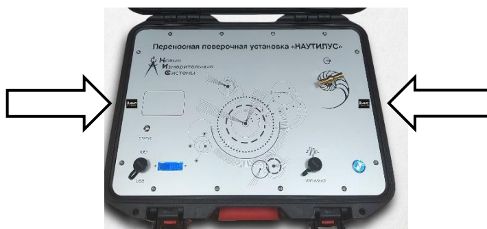
Рисунок 2 – Схема пломбировки от несанкционированного доступа, обозначение места нанесения знака поверки установок
